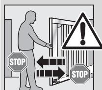
Visas personas, kas lieto vārtu mehānismu, ir jāinstruē par drošu to ekspluatāciju saskaņā ar priekšrakstiem. Demonstrējot pārbaudiet mehānisko atbloķēšanas mehānismu un vārtu drošības atpakaļgaitu. Vārtu aizvēršanās laikā ar abām rokām pieturiet tos. Vārtu mehānismam ir jāievada vārtu drošības atpakaļgājiens.
